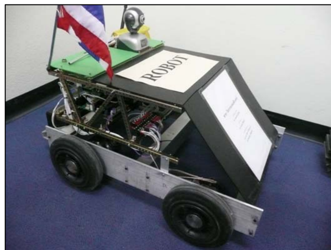
หุ่นยนต์ตรวจการณ์รุ่นแรกเคลื่อนที่ด้วยล้อยาง
